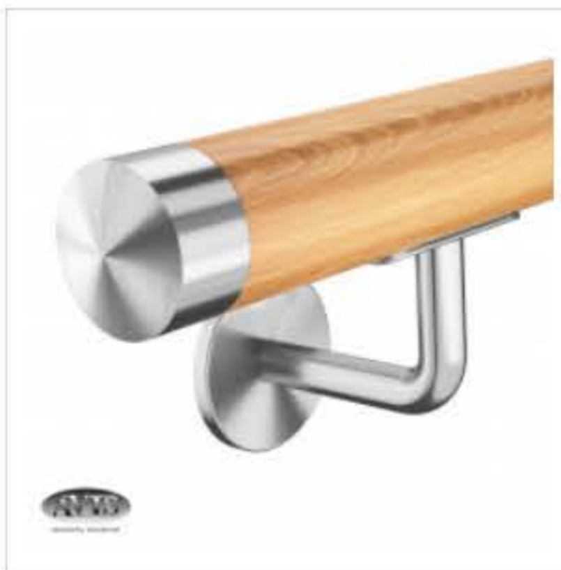
Poręcz Ø42,0 mm, wsporniki model S111, drewno dębowe, bejca + lakier bezbarwny
